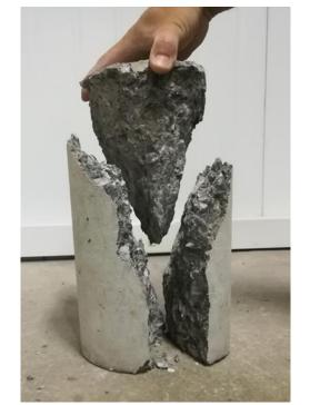
Fig. 3 – Roturas satisfactorias en probetas cilíndricas
