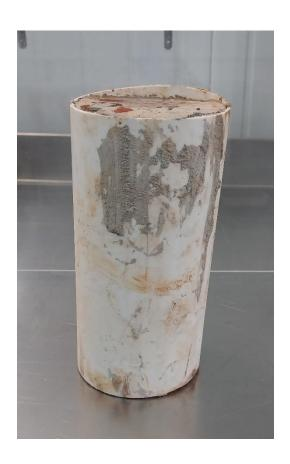
Probeta mal confeccionadas
