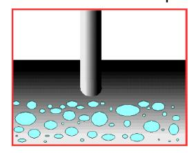
Al introducir el vibrador en forma lenta, la capa superior será compactada. Las burbujas de aire y la lechada de cemento sobrante no podrán subir desde la capa inferior a la superficie.
