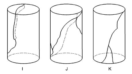
Fig. 4 — Ejemplos de roturas no satisfactorias en probetas cilíndricas
