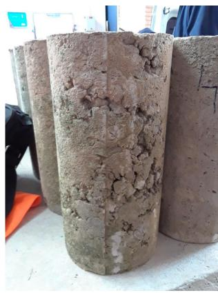
Probeta mal confeccionadas
